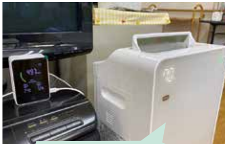
CO2センサー、空気清浄機を設置することで、空調管理を強化します。
